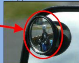
ほじょ しかく 補助ミラーでは死角にいる 自動二輪車を確認できる。
