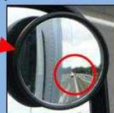
ほじょ まうし 補助ミラーでは真後ろの 緊急車両を確認できる。
