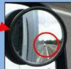
ほじょ まうし 補助ミラーでは真後ろの 緊急車両を確認できる。
